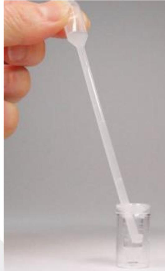
Con ayuda de una pipeta de transferencia, tomar 0,5 ml del sobrenadante y colocarlo en un tubo de 1,5 ml.
