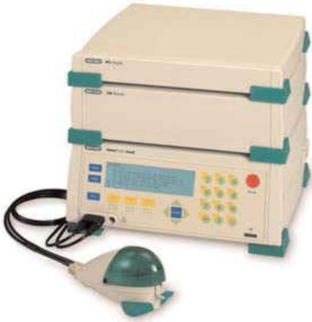
Electroporador: equipo que crea un campo magnético que altera la permeabilidad de las membranas celulares.
