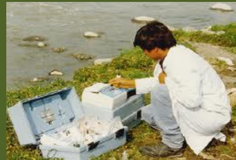
Análisis de muestras de agua en campo: pH, Conductividad eléctrica
